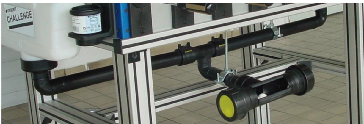
Bild: Ballrückführung durch PE Rohre
