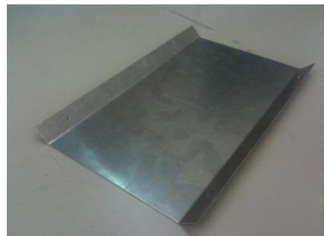
Zum Schluss wurde das Blech an zwei Stellen im 135 Grad Winkel, für die anschließende Montage am Tisch, gebogen.
