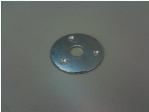
Aluminiumblech. Die runde Form des Teils entstand durch nibbeln und anschliessendes abschleifen. Nach dem Entgraten und Anfassen auf der Vorderseite, wurde bei allen drei, zuvor mit der Stanzmaschine gefertigten Schraubenlöchern, eine Absenkung mit dem Bohrer gemacht. Beim Abrunden der Lager war Geduld gefragt, da das Material ansonsten überhitzt und somit beschädigt würde.
