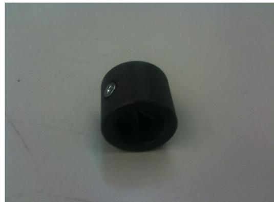
durchgeführt). Am Ende wurde das Teil noch von Hand entgratet und es wurde eine Bohrung inkl. Absenkung für die Schraube gefertigt.
