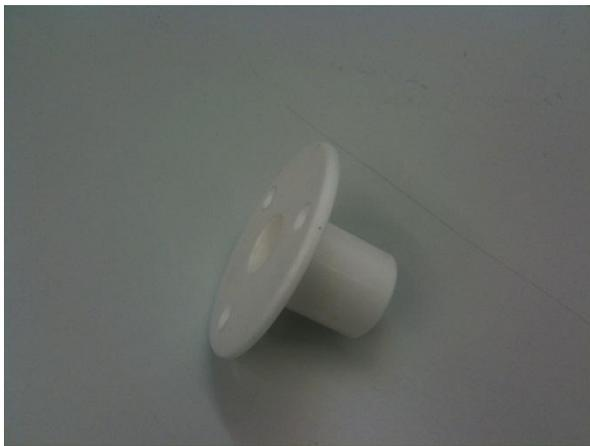
das Teil umgespannt und die gleichen Arbeitsschritte durchgeführt wie auf der ersten Seite, mit dem Unterschied, dass man die Spannzange mit genau 25mm Durchmesser benutzen konnte um das Gleitlager zu befestigen. Zusätzlich wurden noch die Bohrung gemacht (Zentrierbohrer, Bohrer, Ausdrehstahl), welche einen genauen Durchmesser von 16.4mm haben. Dieses Mass ist sehr wichtig, da die 16mm Stangen
